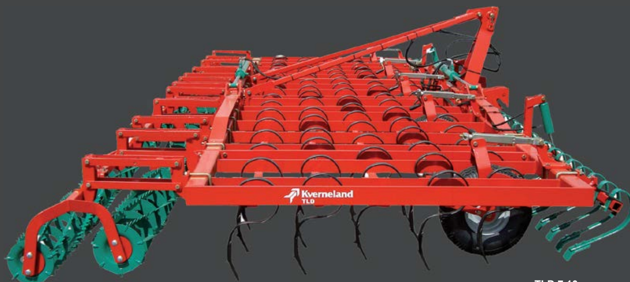
TLD 7.10m sa ravnajućom letvom / ravnačkom daskom i duplim ozubljenim valjcima za mrvljenje
