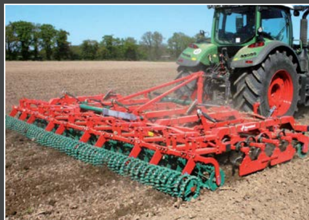
Kombinacija ozubljenog valjka za mrvljenje i crosskill valjka.
