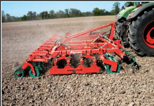
TLG je opremljen sa sekcijom za razbijanje grumenja i kombinacijom ozubljenog valjka za mrvljenje i crosskill valjka.
