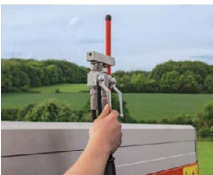
Ventil za zatvaranje levo/desno, za zasebno rasipanje upola radne širine
