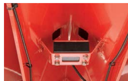
1x referentni senzor, jedinstven kod Kverneland Exacta-e
