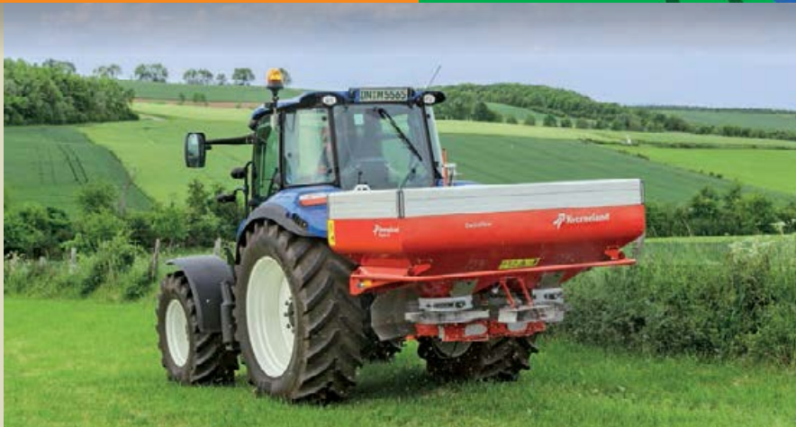
Rasipanje uz među koristeći ploču za rasipanje uz među (dostupna ručna ili hidraulična verzija)
