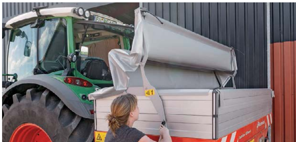
Jednostavan sistem za podizanje/spuštanje cerade spremišta
