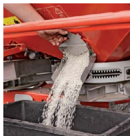
Oprema za pražnjenje spremišta
