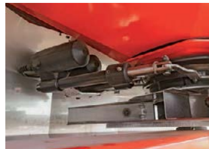
Dva priključka na dozirnim jedinicama, namenjena nadzoru mesta ispusta i količine rasipanja
