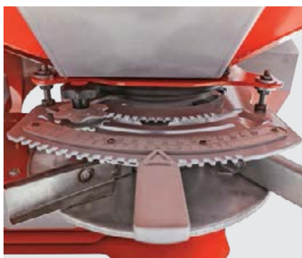
Oprema za podešavanje količine rasipanja sa zadnje strane uređaja je lako dostupna i podesiva
