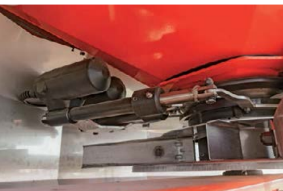
Dva pogona na jedinicama za doziranje, namenjena kontroli mesta ispusta i količine rasipanja
