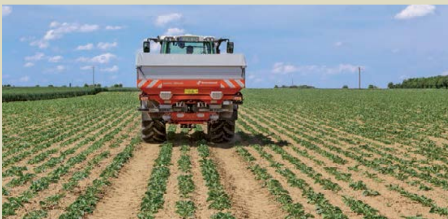
Rasipanje uz među koristeći sistem ExactLine
