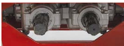
Središnji reduktor sa dva priključka za podešavanje brzine diska
